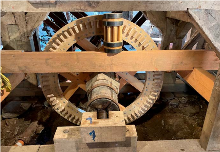
Kronhjulet med drev. Den ursprungliga bockkonstruktionen, som kallas kvarnstolen, syns i bakgrunden. På den vilar golv och kvarnmaskineriet.
